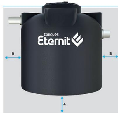
Realizar la base "A" de 25 cm con hormigón pobre luego llenar el biodigestor con agua y repetir el proceso en los laterales "B" del mismo modo hasta el cuello del tanque una vez realizada la unión de entrada y salida.
